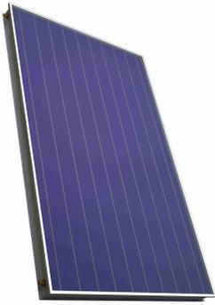
El captador **ASTERSA AS-2.4 M** está fabricado con un absorbedor continuo de cobre con tratamiento selectivo BLUETEC soldado por ultrasonidos a un colector de tipo parrilla. Las soldaduras en el absorbedor se realizan por inducción. El marco está extrusionado al 100% y anodizado de alta calidad. Vidrio solar templado de alta resistencia y baja emisividad. Cubierta posterior en PE térmico.
